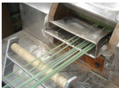
ストランドと造粒機。ひも状の樹脂を細かくカットすればペレットの完成です。
