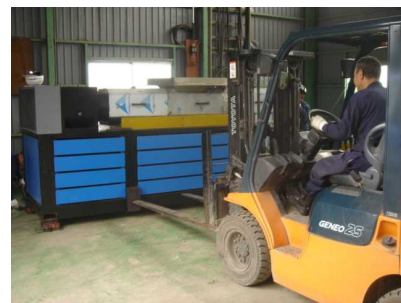
重～い機械の下に車を入れて、フォークリフトで押して少しずつ動かします。
