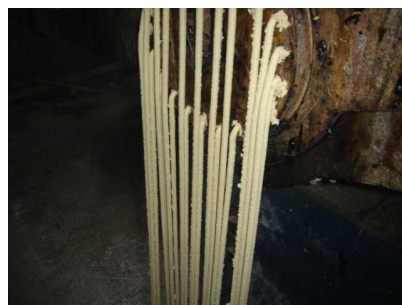
混練不十分な状態。 ダレてしまい、ストランド(溶かしたプラスチックを糸状に押し出したもの)がうまく引っ張れません。
