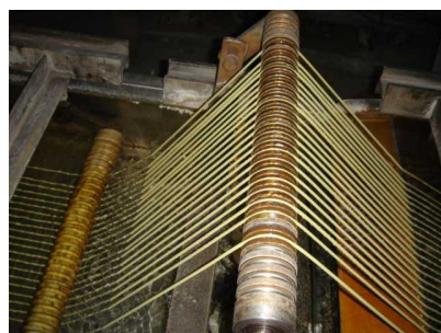
これが十分に混練した状態のストランド。 きれいな糸状になります。
