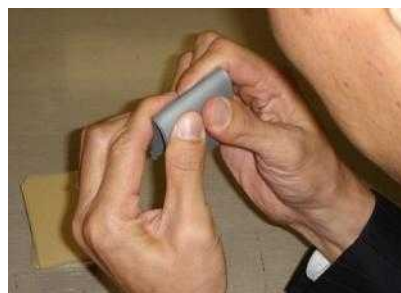
アルミ蒸着ペレットから出来た試験片。折り曲げた部分の状態、きちんと樹脂が混ざり合っているかがチェックできます。
