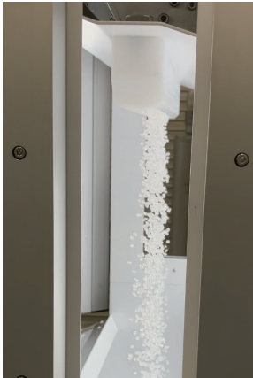
1cm程度の幅を流れるペレット（左）を手前と奥に設置した各3台のカメラで撮影する。光源はLEDを使用
