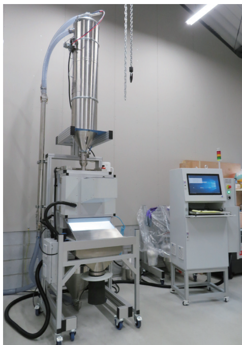
インスペクトテクノロジーズ日本拠点に設置しているペレット検査・選別システム
